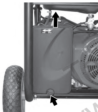
Демонтаж на капака на въздушния филтър
